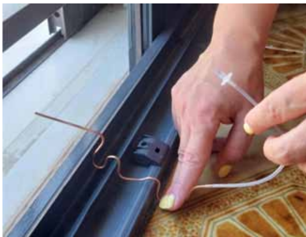
Ειδικό σωληνάκι μέτρησης της εξωτερικής πίεσης με το κούφωμα κλειστό
