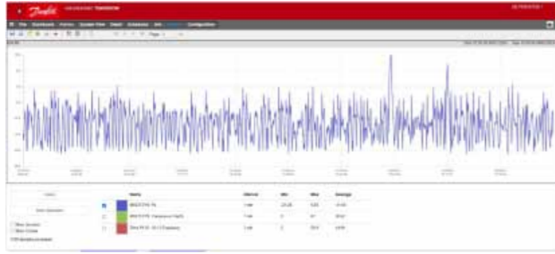
Θερμοκρασία εξάτμισης χωρίς Inverter
