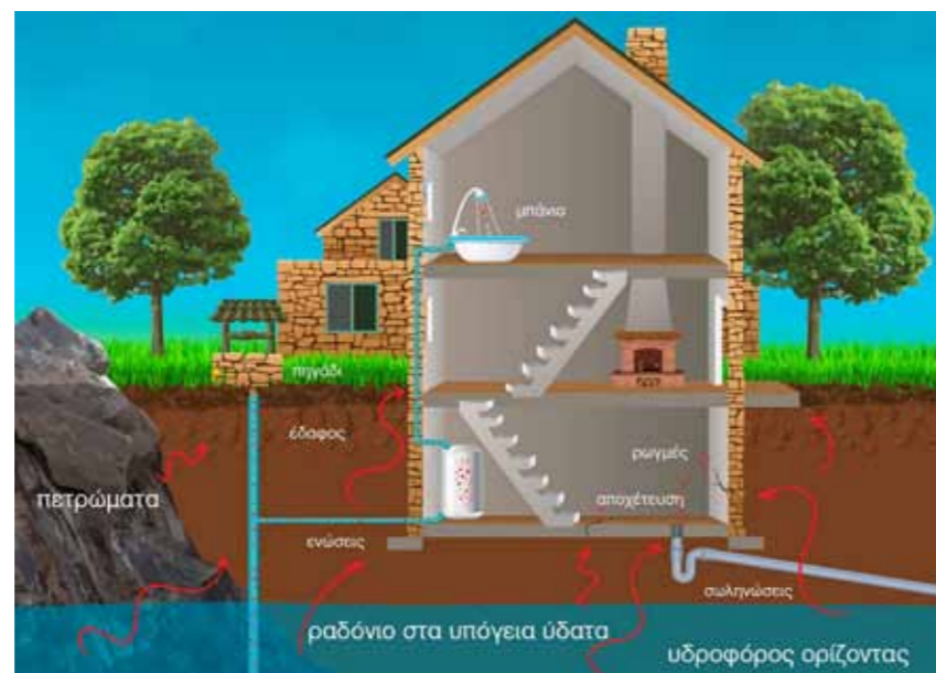
Εισροή Ραδονίου σε οικία (πηγή: ΕΕΑΕ «Όλα όσα θέλετε να γνωρίζετε για το ραδόνιο», Σεπτέμβριος 2015)
