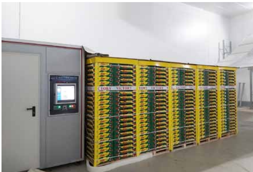
Εικόνα 2: Μεταφερόμενη συσκευή δυναμικής πρόψυξης σε λειτουργία.
