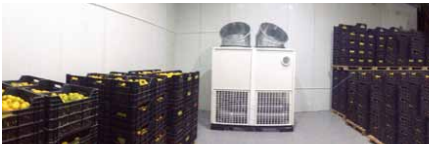
Εικόνα 2: Μεταφερόμενη συσκευή δυναμικού αποπρασινισμού γεωργικών προϊόντων τοποθετημένη σε ψυκτικό θάλαμο έτοιμη για λειτουργία.
