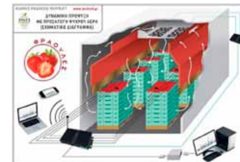
Δυναμικό προψυκτήριο προσαγωγής ψυχρού αέρα για φράουλες με σχηματική απεικόνιση της κίνησης του ψυχρού αέρα και των εξαρτημάτων ελέγχου και ρύθμισης των παραμέτρων πρόψυξης.
