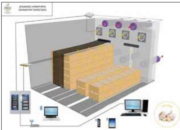
Δυναμικό Ξηραντήριο αναρρόφησης με δύο θέσεις ξήρανσης και με σχηματική απεικόνιση της κίνησης του θερμού αέρα και των εξαρτημάτων ελέγχου και ρύθμισης των παραμέτρων ξήρανσης.
