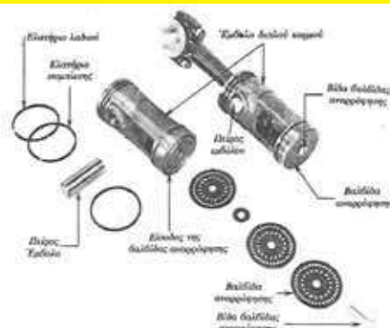
Σχ. 2-47: Έμβολο διπλού κορμού και τα εξαρτήματά του το στροφαλοθάλαμο.
