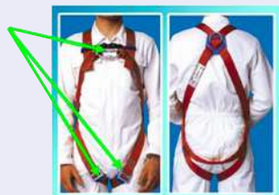
P-15 - Ζώνη Ασφαλείας Τριών Σημείων (2 Σημεία στήριξης) Ολόσωμη ζώνη ασφαλείας τριών σημείων με κρίκους ανάρτησης στην πλάτη και στο στήθος. Σύμφωνα με το EN 358-361
