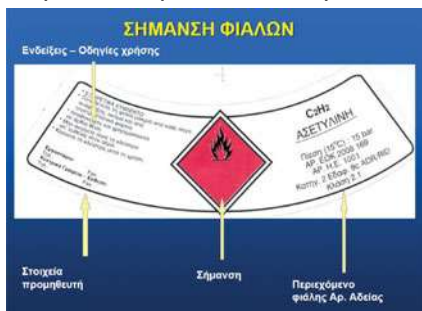
Απεικόνιση αυτοκόλλητης ενημερωτικής ετικέτας σήμανσης φιαλών πεπιεσμένων αερίων
