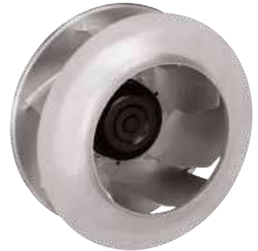
Φώτο 3B: Οι φυγοκεντρικοί ανεμιστήρες RadiPac όπως ο τύπος R3G355 που χρησιμοποιούνται στο Airblock C, με αλουμινένια φτερωτή και τεχνολογία εξοικονόμησης ενέργειας EC εξοικονομούν χώρο σε σύγκριση με τους ιμαντοκίνητους κινητήρες.
