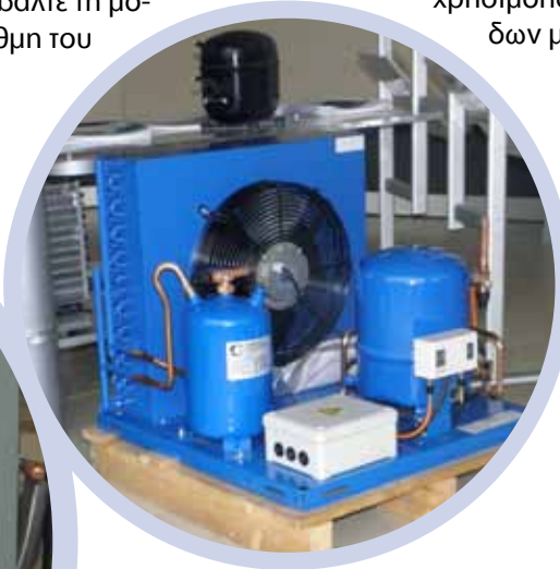
Ψυκτικό συγκρότημα με συμπιεστή κλειστού τύπου
