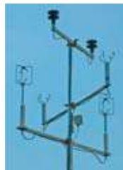
Σχήματα 10 α,β. Ανεμόμετρα: αριστερά κλασικό τύπου κυπέλλου, δεξιά νέου τύπου – δύο διευθύνσεων.
