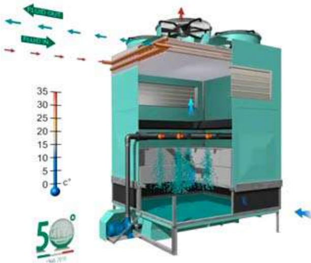
Σχήμα 4: Ενεργοποίηση κυκλώματος νερού
