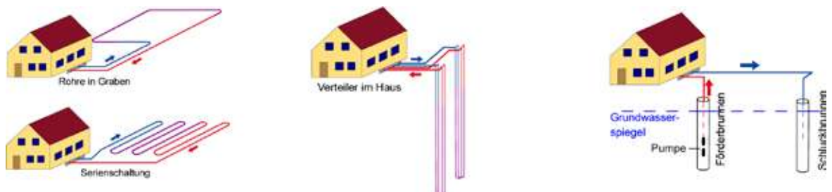
Εικόνα 1: Διατάξεις ΓΕΘ: οριζόντιοι (α), κατακόρυφοι (β), υδρογεωτρήσεις παραγωγής και επανεισαγωγής (γ)
