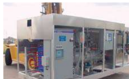
Chiller αμμωνίας 200 KW
