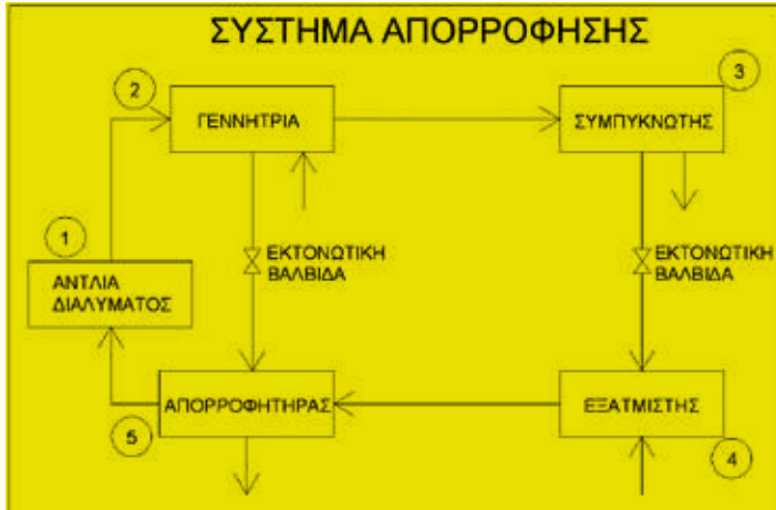
Σχήμα 1 Σχηματικό διάγραμμα βασικού απορροφητικού συστήματος με LiBr
