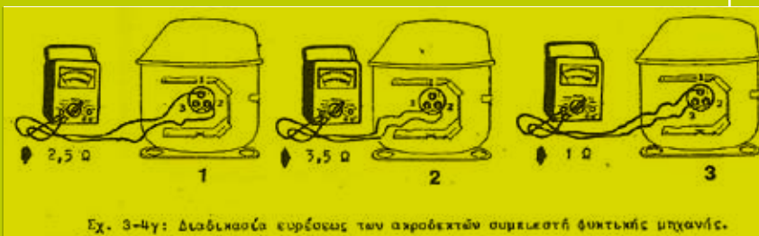
Σχ. 3-4γ: Διαδικασία εύρεσης των ακροδεκτών συμπιεστή ψυκτικής μηχανής.
