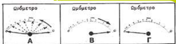
Εκ. 3-Σει Α. Πυκνωτής υγιής. Β. Πυκνωτής βραχυκυκλωμένος. Γ. Πυκνωτής σε κρισιμική κατάσταση.
