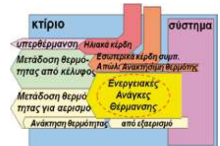
Σχήμα 1 Υπολογισμός των θερμικών αναγκών για θέρμανση κτιρίου με συνολικό ισοζύγιο που περιλαμβάνει το σύστημα θέρμανσης, την ανάκτηση ενέργειας και τα ηλιακά και εσωτερικά κέρδη
