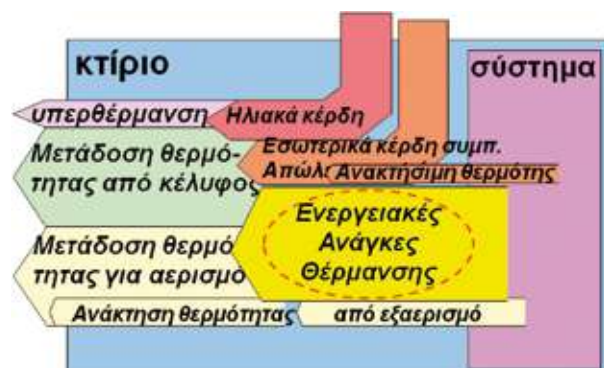
Σχήμα 2 Υπολογισμός των θερμικών αναγκών για θέρμανση κτιρίου με συνολικό ισοζύγιο που περιλαμβάνει το σύστημα θέρμανσης, την ανάκτηση ενέργειας και τα ηλιακά και εσωτερικά κέρδη [4]
